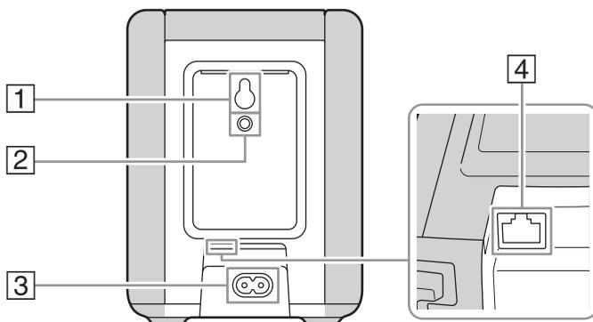
1 **Orifice pour suspension au mur** (☞ P.4)
