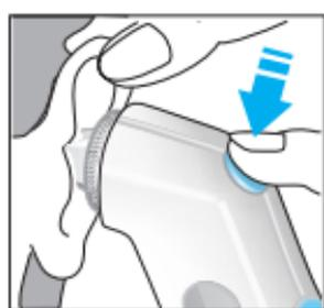
4. Bien introduire la sonde (3) dans le conduit auditif, puis appuyer sur le bouton de mise en marche « start ». Un bref bip indique le début de la mesure.
