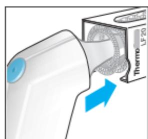
1. Pour obtenir des mesures précises, s'assurer qu'un filtre de lentille neuf et propre (2) est en place avant chaque prise de température.
