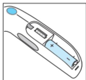
Ouvrir le logement de pile. Retirer la pile et la remplacer par une neuve en suivant les indicateurs de polarité. Remettre le couvercle de pile en le glissant jusqu'à ce qu'il s'enclenche.
