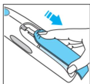
Le thermomètre comprend une pile de type AAA de 1,5 V (LR3). Pour un rendement optimal, nous recommandons les piles alcalines Duracell®. Insérer une pile neuve lorsque le symbole de la pile s'affiche.
