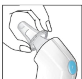
5. Pour la mesure suivante, retirer le filtre de lentille utilisé, et fixer un filtre de lentille neuf et propre. Effacer le message sur l'afficheur en appuyant une fois sur le bouton de mise en marche « start ». Bien introduire la sonde dans le conduit auditif, puis appuyer sur le bouton de mise en marche « start ».
