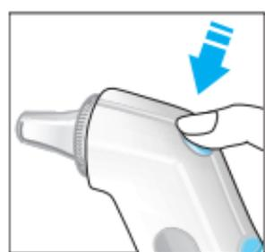
2. Pour mettre le thermomètre en marche, appuyer sur le bouton « start » (4).
