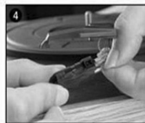
4 Délogez la partie rouge contenant l'aiguille, vous pouvez vous aider d'un tournevis pour faire lever.
