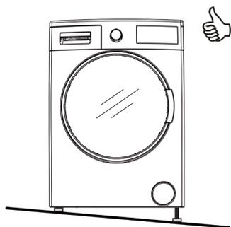
Il est impératif de mettre votre lave linge de niveau. Pour cela, il sera nécessaire d'utiliser un niveau à bulle.
