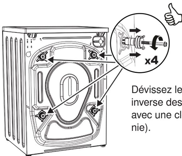
Dévissez les 4 vis dans le sens inverse des aiguilles d'une montre avec une clé appropriée. (non fournie).
