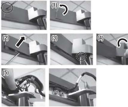
4. Débranchez le connecteur du câblage de la porte du réfrigérateur. (Sur les modèles avec affichage externe uniquement)
