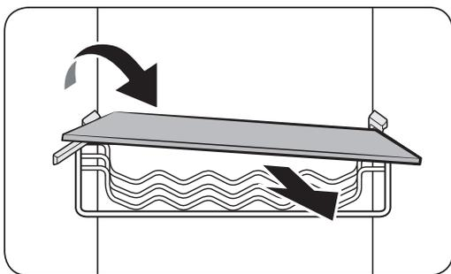
2. Inclinez la clayette (ou le casier à bouteilles de vin) en diagonale pour la/le retirer.
