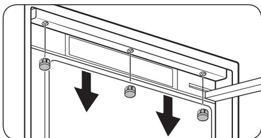
1. Ouvrez la porte du réfrigérateur et utilisez un tournevis à tête plate pour retirer les 3 obturateurs de vis sur le dessus de l'unité principale.
