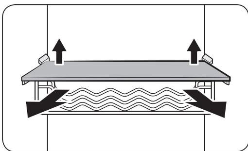
1. Soulevez légèrement l'arrière de la clayette (ou du casier à bouteilles de vin) pour la/le retirer.
