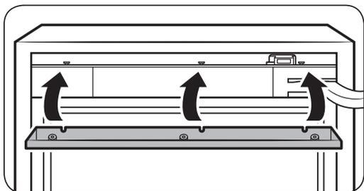
5. Réinsérez le cache de dessus et serrez les vis (x3) pour fixer le cache de dessus.
