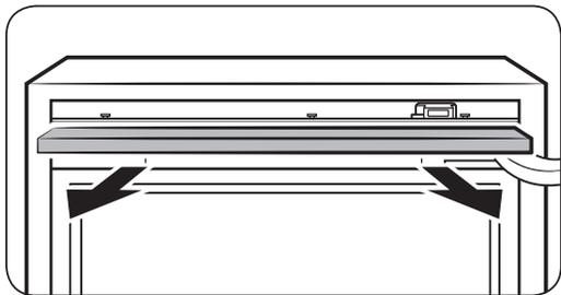
3. Soulevez doucement le cache de dessus pour le retirer. Le port de la clé électronique est ainsi révélé.
