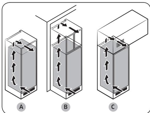
La sortie d'air peut être positionnée de trois façons différentes, en fonction du meuble :
