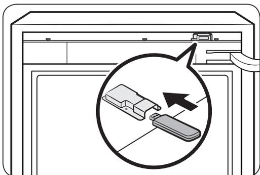
4. Insérez la clé électronique Smart Home Dongle dans le port de clé électronique. Assurez-vous que la clé électronique entre correctement.
