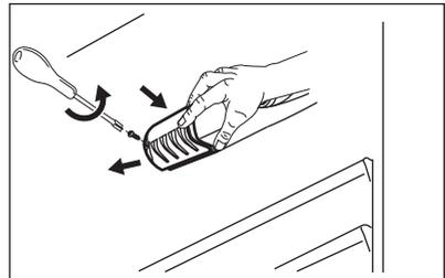
3. Remplacez l'ampoule défectueuse par une ampoule neuve de puissance et de forme identiques, spécifiquement conçue pour les appareils électroménagers. La puissance maximale est indiquée sur le diffuseur.
