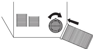
Fixez solidement le tuyau de ventilation à la sortie à l'arrière du sèche-linge.
