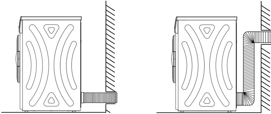
Placez l'autre extrémité du tube contre le mur et marquez l'emplacement sur le mur là où vous souhaitez percer.
