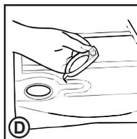
5. Remettez la plaque de protection en place en engageant les charnières du haut et en enclenchant les attaches inférieures en place.
