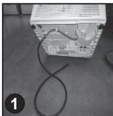
2. Le tuyau d'évacuation des eaux usées se trouve du côté droit de la machine (voir ci contre). Un tuyau gris est branché sur le raccord sur le côté gauche. A l'aide d'une pince, retirez l'étrier de fixation du tuyau de raccord.
