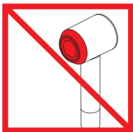
La sortie d'air, l'anneau en métal, les accessoires et la zone indiquée en rouge peuvent être chauds pendant l'utilisation. Laissez-les refroidir avant toute manipulation.
