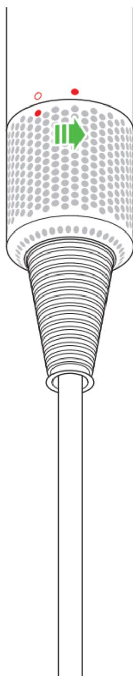
Remplacez la grille du filtre par un mouvement de rotation, en veillant à ce qu'elle soit bien alignée.
