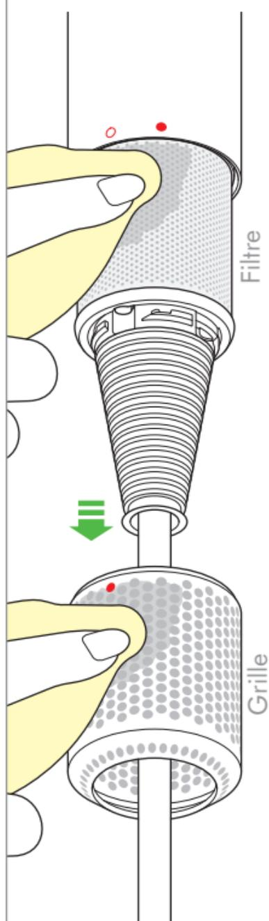
Tirez-la vers le bas pour la retirer de l'appareil. À l'aide d'un chiffon non pelucheux ou d'une brosse douce, retirez la poussière et les débris de la grille du filtre et du filtre.
