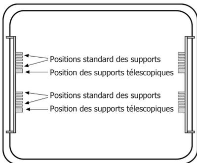
S'assurer que le support est solidement appuyé contre la position d'arrêt à l'arrière de la cavité du four
