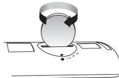
3. Utilisez une pièce de monnaie adaptée pour tourner le couvercle de la batterie de la télécommande dans le sens des aiguilles d'une montre jusqu'en butée pour le remettre en place.
