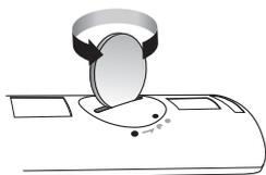
1. Utilisez une pièce de monnaie adaptée pour tourner le couvercle de la batterie de la télécommande dans le sens inverse des aiguilles d'une montre pour le retirer comme indiqué sur la figure ci-dessus.
