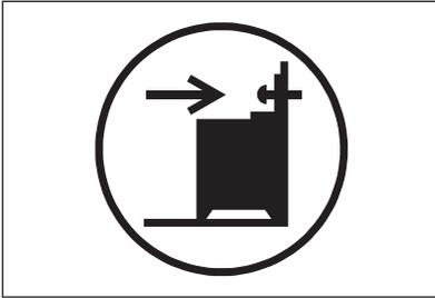
1. Installez la protection anti-bascule 232 - 237 mm en-dessous de la surface supérieure de l'appareil et à 110 - 115 mm à côté de l'appareil, dans l'orifice circulaire situé sur un support. Vissez-la dans un matériau solide ou utilisez un renfort adapté (mur).
