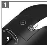
Druk 5 seconden op de lungo-knop als de machine uit staat.
