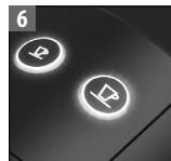
Indicatielichtjes knipperen: machine warmt op.
