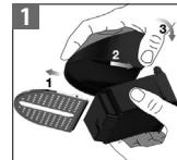
Pour assembler le support de tasse avec le bac d'égouttage: enlevez la grille, placez-les l'un contre l'autre. Clipez le bac d'égouttage dans l'encoche du support de tasse.
