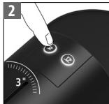
Druk 3 seconden op de espresso-knop als de machine uit staat. De espresso-knop knippert als de spaarstand is ingeschakeld.
