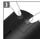
Appuyez simultanément sur la touche Espresso et Lungo pendant 3 secondes. Les deux voyants clignotent alternativement. Patientez jusqu'à ce que l'eau ne s'écoule plus.
