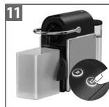
Druk na het vullen op de lungo-knop om de machine door te spoelen. Herhaal stap 10 en 11 nog één keer wanneer de watertank leeg is.
