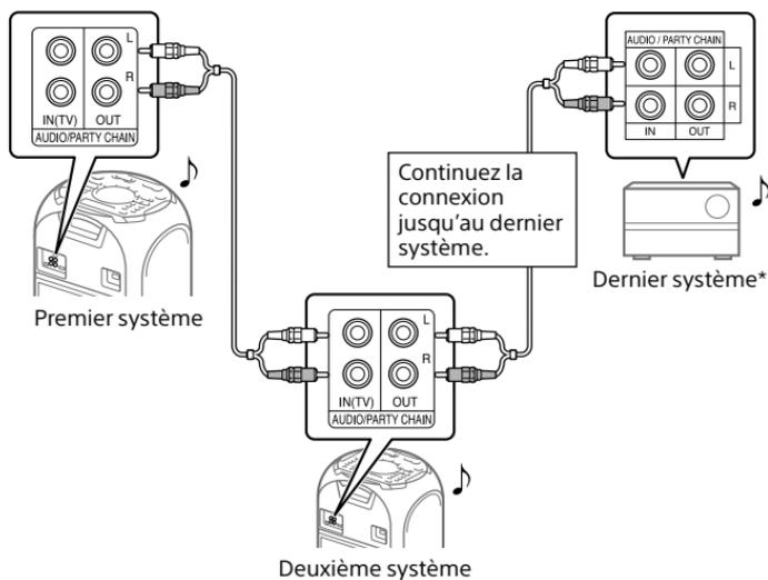
\* Connectez le système qui n'est pas doté de la fonction Chaîne pour soirée câblée au dernier système. Sinon, la chaîne s'arrête à ce système. Pensez à sélectionner la fonction Entrée audio sur le dernier système.
