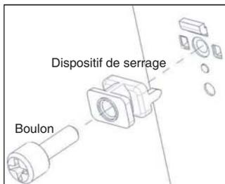
2. Alignez la poignée de porte sur le dispositif de serrage et tirez sur la poignée vers le bas.
