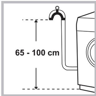
Raccorder le tuyau d'évacuation, sans le plier, à un conduit d'évacuation ou à une évacuation murale placés à une distance du sol comprise entre 65 et 100 cm ;
