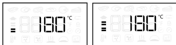
Une flèche clignotante en boucle à côté de la température cible indique la phase de préchauffage.
