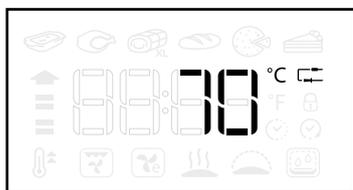
Si le thermomètre à viande est inséré pendant la sélection d'une fonction, l'écran passe à la température cible par défaut du thermomètre à viande.
