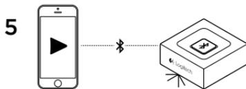
3. Appuyez sur le bouton de couplage *Bluetooth* sur l'adaptateur Logitech *Bluetooth* Audio Adapter. Le couplage démarre et le témoin lumineux commence à clignoter. Lors de la première utilisation, le processus de couplage démarre automatiquement.
