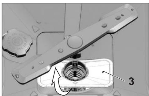
3. Pressez les deux cliquets du gros filtre vers l'intérieur et séparez le gros filtre de l'assemblage.
