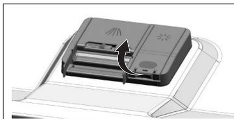
2. Remplissez le réservoir jusqu'au niveau « MAX ».
