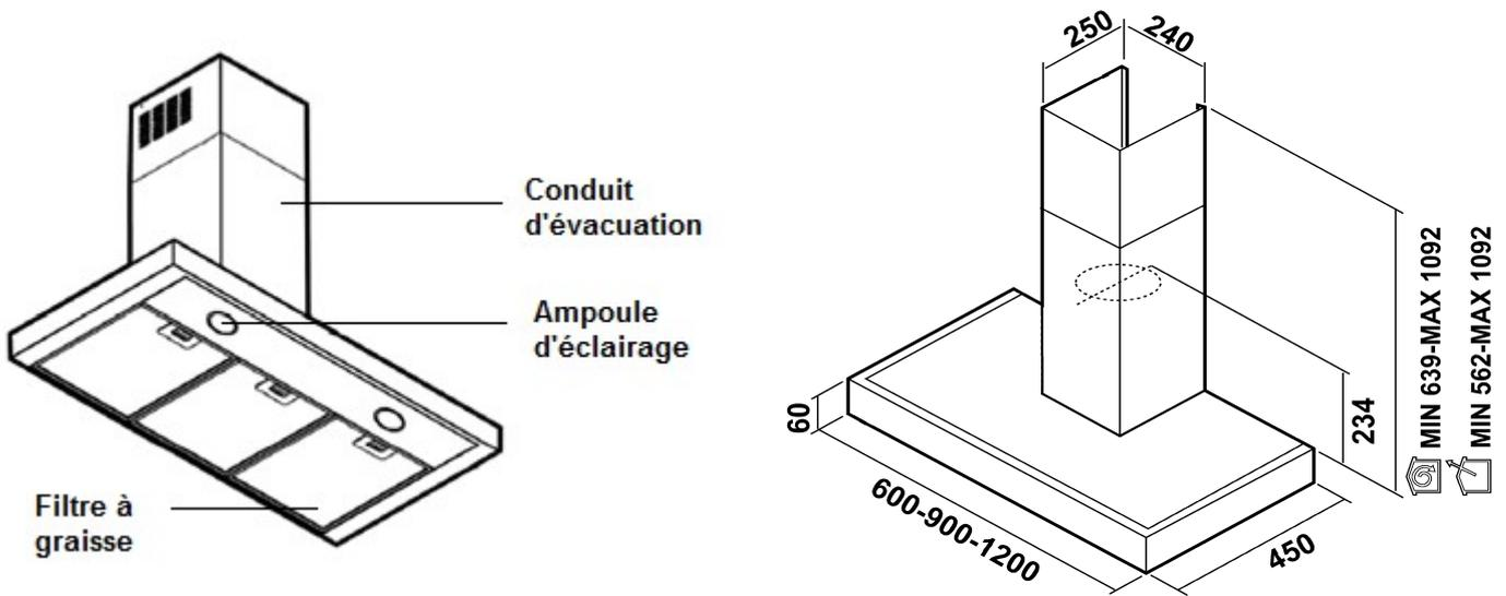
La hotte peut être utilisée en version aspirante à évacuation extérieure, ou filtrante à recyclage intérieur.
