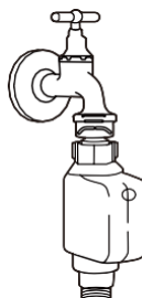
tuyau d'arrivée d'eau de sécurité
