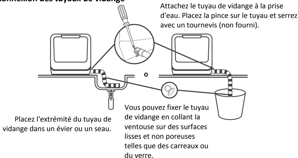
En cas de fuite, fermez immédiatement l'alimentation en eau et inspectez intégralement les raccords du tuyau. Resserrez les raccords si nécessaire.
