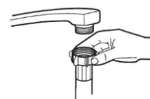
et sans impuretés. Cette précaution permet d'éviter le risque d'obstruction dans l'arrivée d'eau et les dégâts correspondants que cela pourrait causer à la machine.
