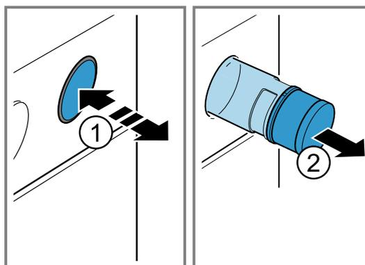
2. Appuyez sur le couvercle du réservoir d'eau ① et ouvrez-le ②.
