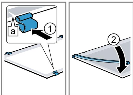
3. Placer la vitre intermédiaire avec les joints et les écarteurs dans le sens de la flèche ①.
