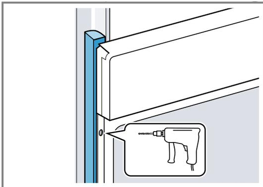
4. Fixez l'appareil avec une vis adéquate.
