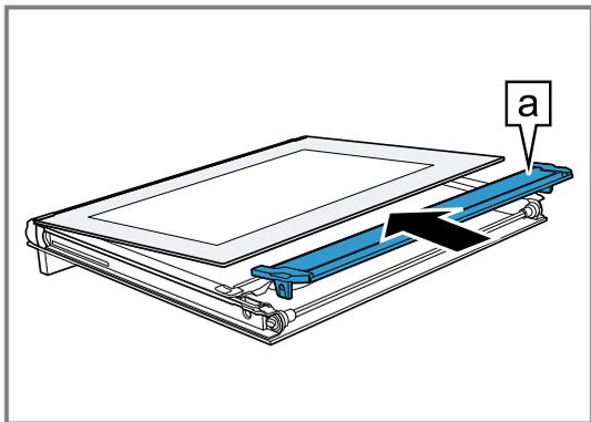
8. Insérer la vitre intérieure avec la fixation
