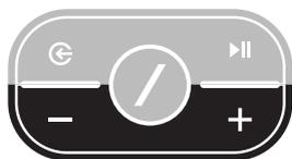
La commande du volume sur vos enceintes Omni 20+ ou Omni 10+ est simple. Appuyez sur le bouton Volume + du haut de l'enceinte pour augmenter le volume ou appuyez sur le bouton Volume – pour diminuer le volume. Appuyez simultanément sur les deux boutons de volume pour couper le son de l'enceinte. Si l'enceinte est coupée, toute modification du volume le rétablira automatiquement.
