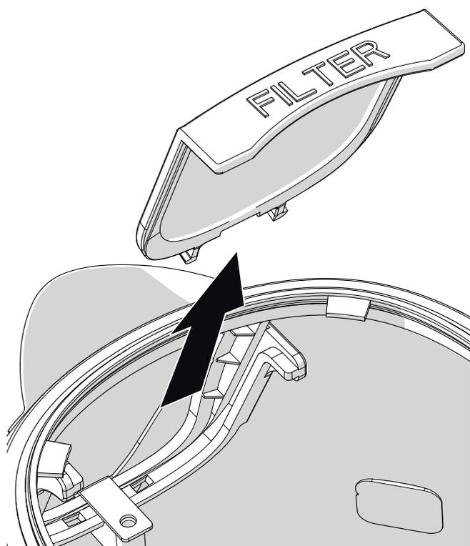
3. Réinsérez le filtre dans son logement derrière le bec de la bouilloire.
