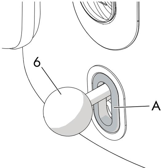
Le levier d'allumage/extinction active/interrompt le cycle d'ébullition. Quand la bouilloire est en fonction, la DEL **A** s'allume en devenant blanche.
