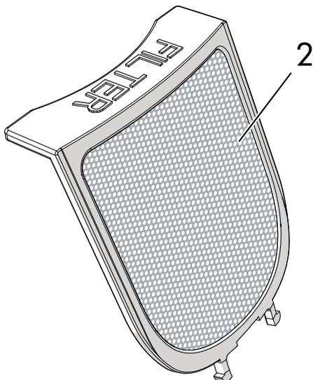
Le filtre en acier inox est situé derrière le bec anti-goutte. Il retient le calcaire présent dans l'eau.
