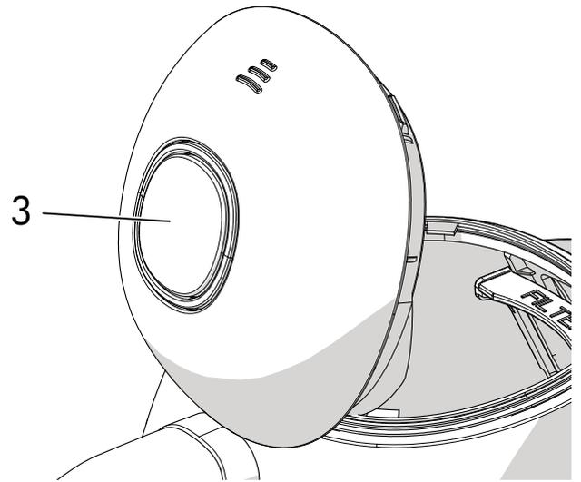
Le couvercle est muni d'un bouton push-push (3) qui en permet l'ouverture progressive pour éviter l'échappement inattendu de vapeur bouillante.
