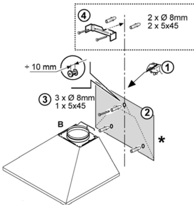
4. Accrochez la hotte sur la vis du haut que vous avez insérée. Retirez les filtres à graisse afin d'accéder aux 2 vis du bas situées à l'intérieur, de chaque côté. Puis positionnez les 2 vis intérieures à l'aide des rondelles fournies.
