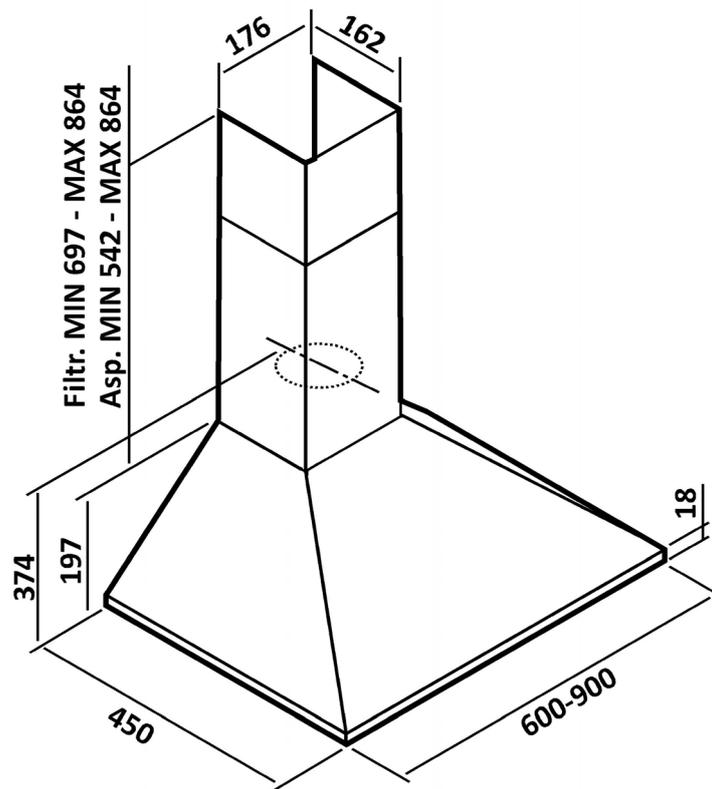
La hotte peut être utilisée en version aspirante à évacuation extérieure, ou filtrante à recyclage intérieur.
