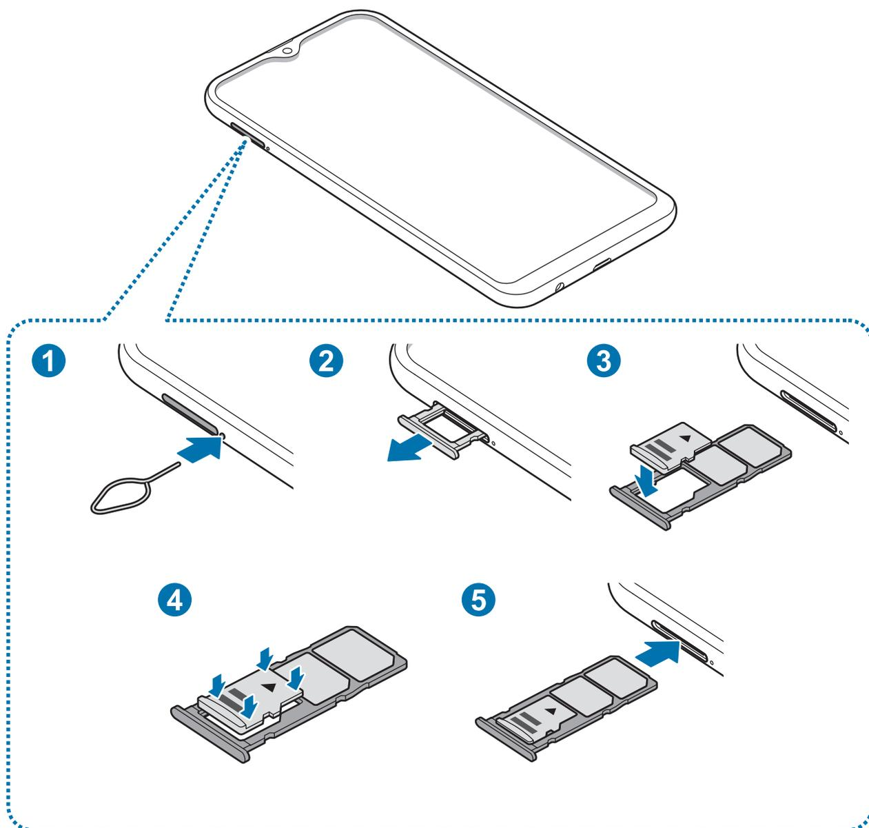
1 Insérez l'outil de retrait à l'endroit prévu à cet effet à côté du compartiment pour le déverrouiller.
