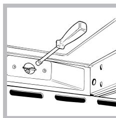
3. déposer le brûleur du four après avoir enlevé la vis V (voir figure); pour simplifier cette opération, démonter auparavant la porte du four.
