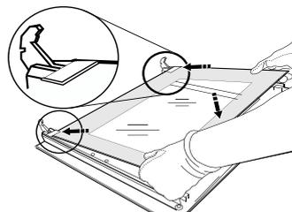
**4.** Remplacez le bord supérieur : un déclic indique le positionnement correct. Assurez-vous que le joint est bien placé avant de replacer la porte.
