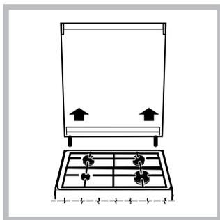
Pour le nettoyage des modèles équipés de couvercle en verre, utilisez de l'eau tiède. Evitez tout produit abrasif. Vous pouvez déposer le couvercle pour simplifier le nettoyage de la zone arrière du plan de cuisson : ouvrez-le complètement et tirez vers le haut (voir figure).
