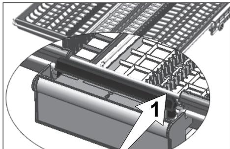
Dans les modèles avec fonction de mouvement partiel, lorsque vous poussez la barre (1) sur la poignée, le plateau central du panier passe à la position inférieure et le système se déverrouille. Ainsi, les plateaux à droite et à gauche peuvent être utilisés comme pièces mobiles.
