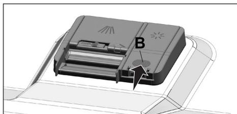
4. S'il y a des taches sur les couverts après le lavage, le niveau doit être augmenté et si vous observez une trace bleue après les avoir essuyés à la main, il doit être diminué. Il est réglé sur le niveau 3 comme réglage d'usine.
