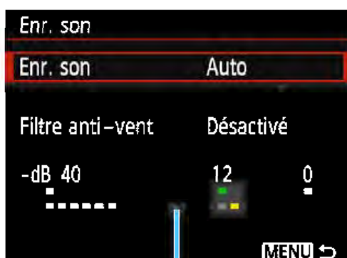
Compteur du niveau
