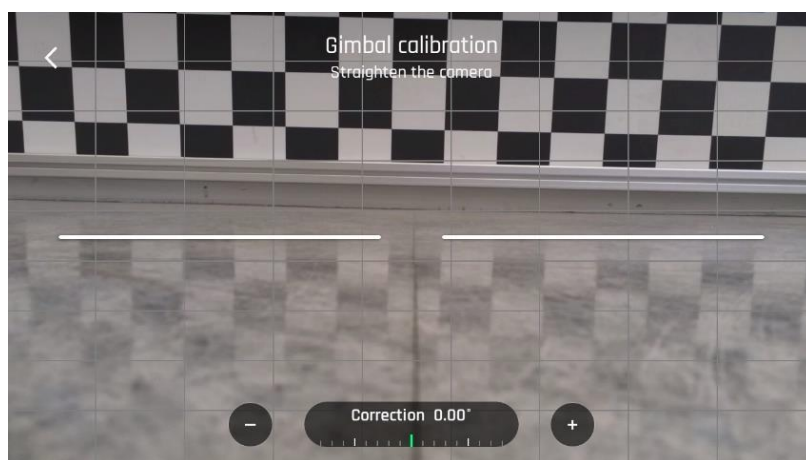
Calibration nacelle/camera : avant
