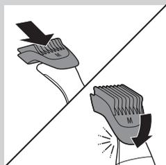
**3** Faites glisser le sabot sur l'avant de la tête de tondeuse de précision et poussez-le vers l'arrière jusqu'à ce qu'il s'enclenche (clic).
