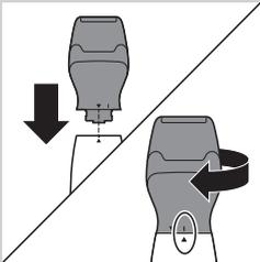
**1** Placez la tête de rasage de précision sur l'appareil (voir la section « Fixation et retrait des accessoires » au chapitre « Avant utilisation »).
