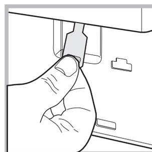
4. se servir de la languette indiquée, tirer vers soi jusqu'à ce que le tirant en plastique se dégage de son cran d'arrêt; tirer ensuite vers le bas et ouvrir l'hublot en même temps.
